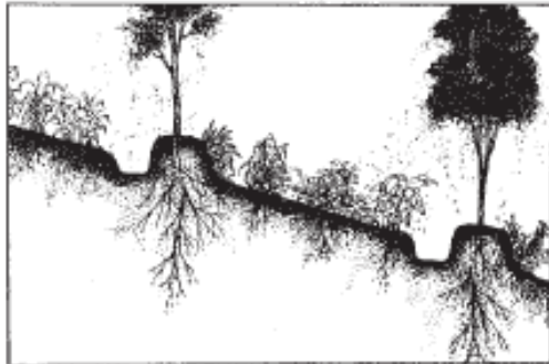
Trincheras en contorno
